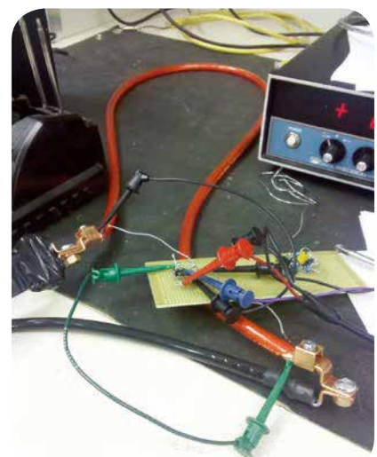
圖2：測試裝備。由於感測線長度影響絕對精度，因此將其連接到電路板的兩根灰色電線為較重規格。
